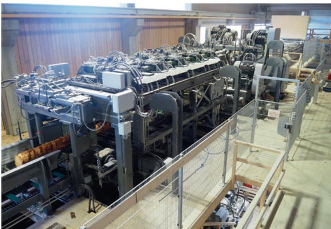
Neue Sägelinie bei Holz Hahn: Einzugsaggregat mit nachfolgender Doppelwellen-Kreissäge im Rundlauf
