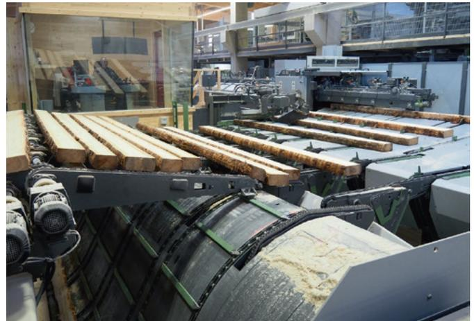
Zuführung zur Optimes-Besäumkreissäge: Am oberen Deck gelangt die Hauptware zur Anlage, von unten kommt die Seitenware vereinzelt zum Manipulationstisch
