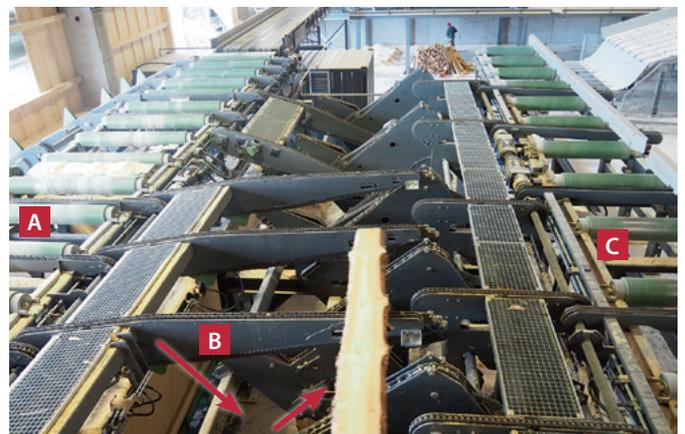
Eine Besonderheit: Von links kommen die Model aus der Kreissäge (A) und werden mehrstielig geschnitten. Der Querförderer (B) lässt sich absenken und die Stücke werden für den Rundlauf (C) vereinzelt
