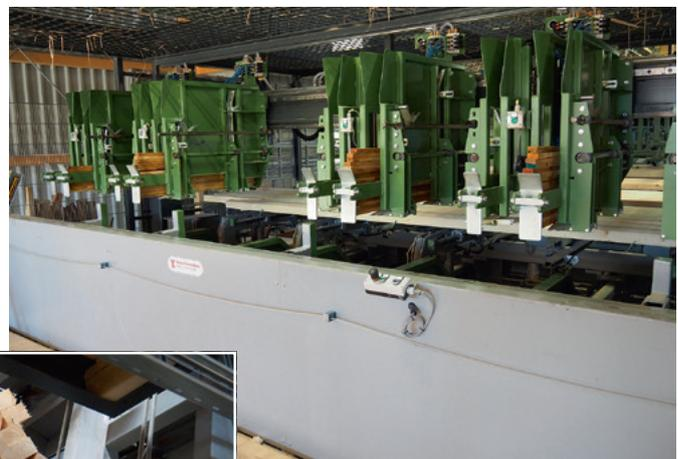
Paketierung mit fünf Doppelmagazinen für Trockenkammer- und Verlustlatten
